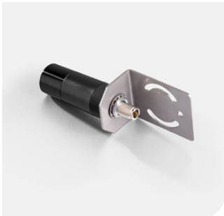
WA-Mount-NF-1 Antennenhalterung Edelstahl-Wandmontagewinkel mit 16,5 mm Montageloch für Antennen. Die Löcher zur Wandbefestigung können auch für Kabelbinder verwendet werden.
