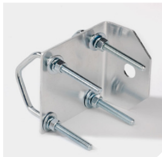
BAM1009 Antennenhalterung Aluminium-L-Bügel zur waagerechten oder senkrechten Montage an Rohren oder Masten. Geeignet für Rohre und Masten mit 38 - 60 mm Außendurchmesser. Loch mit 15,8 mm Durchmesser für die Montage mittel N(f)-Steckverbinders.
