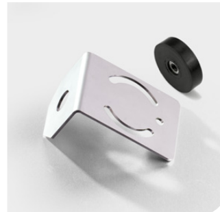
WA-Mount-NF-3 Antennenhalterung Edelstahl-Wandmontagewinkel mit 16,5 mm Montageloch für Antennen. Befestigung an metallischen Oberflächen über beiliegenden Magneten. Die Löcher zur Wandbefestigung können auch für Kabelbinder verwendet werden.
