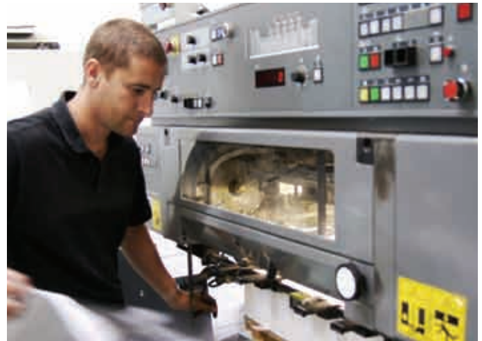
Druckmaschine mit Welotec-Sensoren, u. a. Induktive Hochtemperatursensoren und Laser-Präzisionssensoren zur exakten Positionierung.
