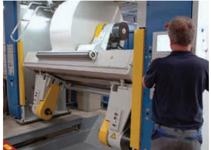
Laserkontrastsensoren für Druckmarken und Abstandssensoren für den Rollendurchmesser
