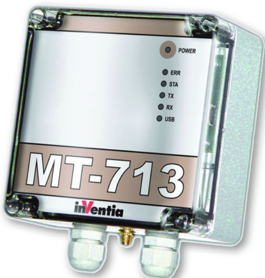
Bild 4. Der kompakte, batteriebetriebene GPRS-Datenlogger bietet fünf binäre und drei analoge Eingänge sowie zwei Steuerausgänge. Dank cleverem Energiemanagement erreicht er Standzeiten von bis zu zehn Jahren. (Foto: Welotec)
